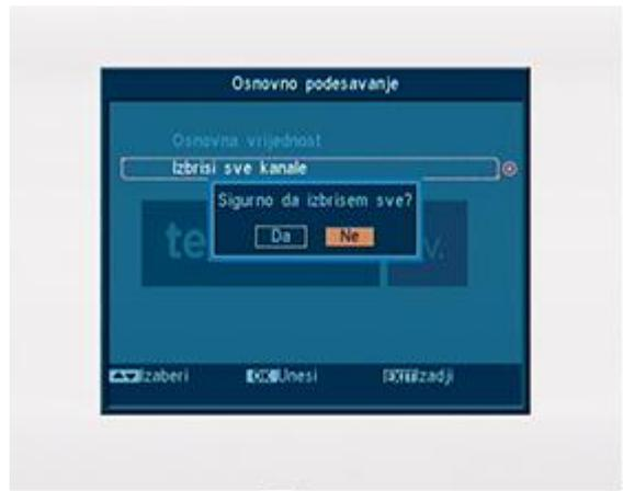
Pritiskom na [OK] tipku kod "Izbriši sve kanale" opcije, pojavit će se dijalog sa upitom da potvrdite brisanje svih kanala. Ukoliko odaberete "OK", svi kanali će biti izbrisani.
